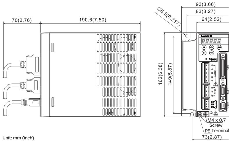
**LXM23CU20M3X, CU30M3X, MU45M3X**
