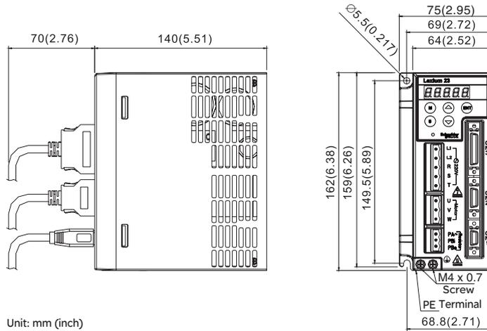
**LXM23CU07M3X, CU10M3X, CU15M3X**
